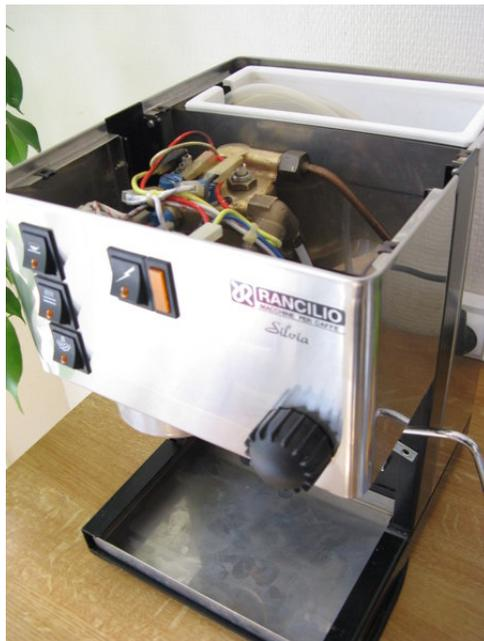
On débranche une cosse de la résistance pour remplir la chaudière sans chauffer, et tester l'étanchéité du circuit.
