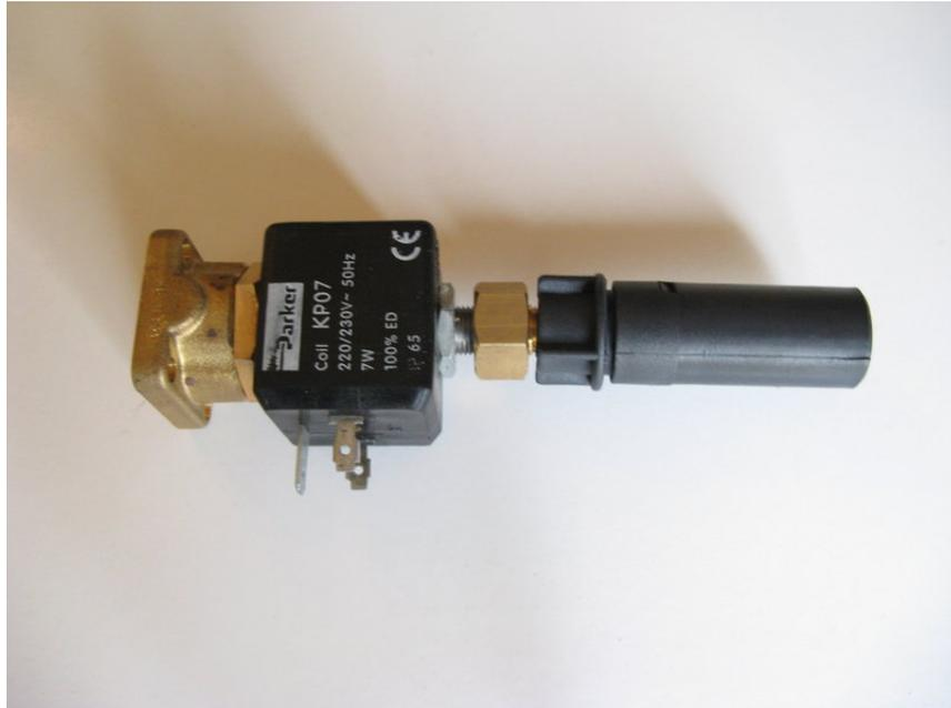
On remonte l'OPV, en prenant soin de ne pas se tromper dans l'ordre des pièces (d'où l'intérêt d'avoir pris des photos)
