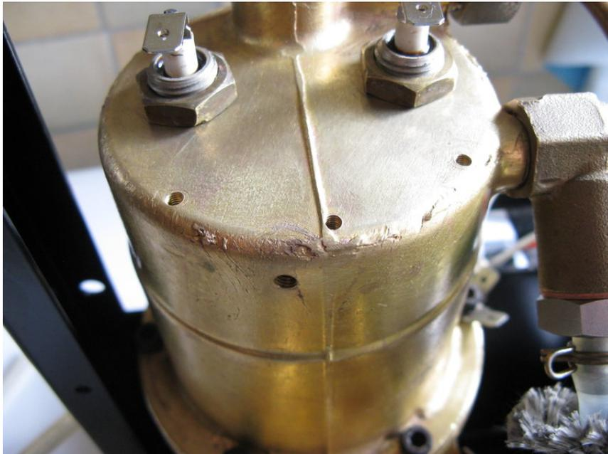
Les trois thermostats en place : café à gauche (110 °C, marqué d'un point rouge), vapeur à droite (140 °C) et sécurité en bas (165 °C, réamorçable).
