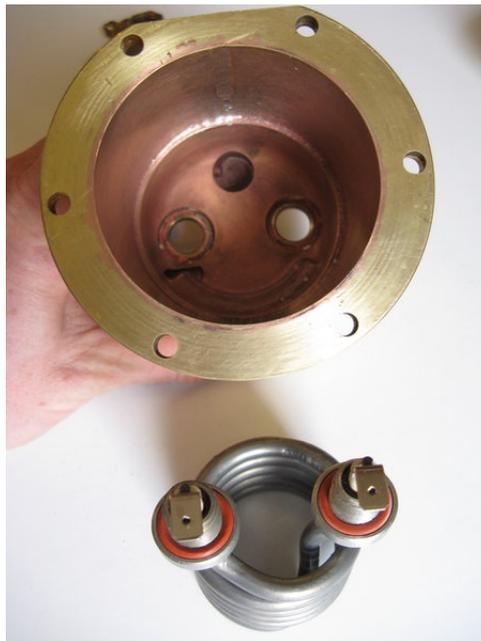
Bien noter le sens, pas grave en soi, mais les cosses sont orientées vers l'avant, se tromper de sens posera un problème pour connecter les fils.
