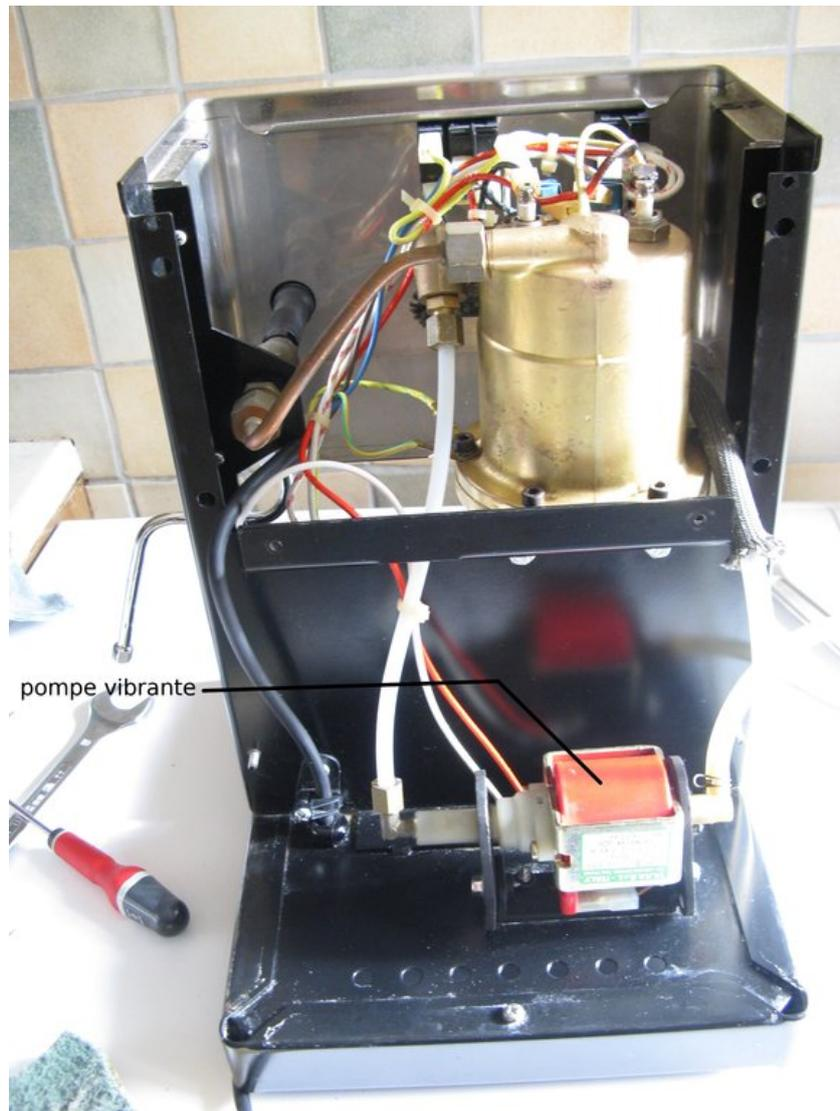
pompe vibrante : comme son nom l'indique, elle pompe l'eau du réservoir pour l'emmener vers la chaudière. C'est la finesse de la mouture dans le filtre qui lui permet de faire monter la pression jusqu'à 9 bars pour un expresso.
