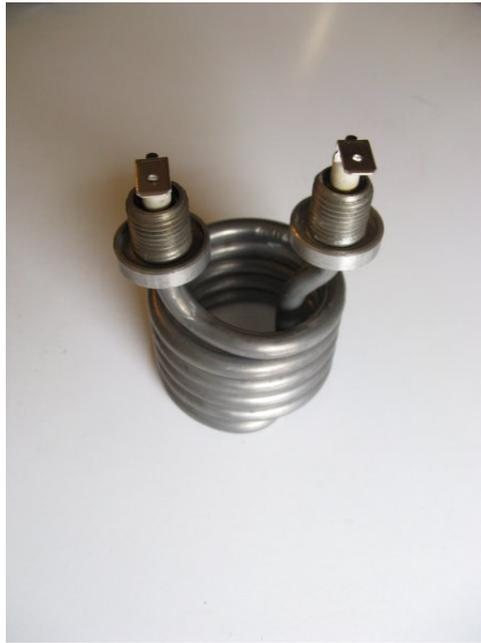
On remonte les deux joints neufs de la résistance. Il va falloir la replacer dans la chaudière.
