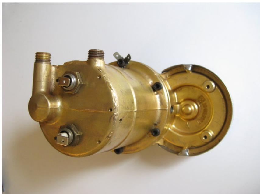
On revise l'opv sur la chaudière (1 ou 2 joints cuivre)
