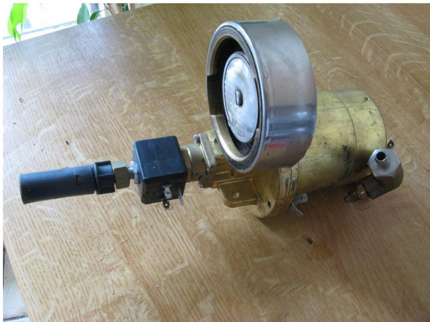
On démonte l'opv. Pour la retirer de la chaudière, on coince l'opv dans un étau et on dévisse en tournant la chaudière. On démonte l'opv en prenant bien soin de noter ou de photographier l'ordre de pièces.
